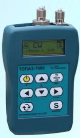
Приборы модельной группы (модификации) ТОПАЗ-73XX-А тестеров оптических серии «ТОПАЗ-7000» являются профессиональным измерительным оборудованием и объединяют в себе источник оптического излучения и измеритель оптической мошности.
